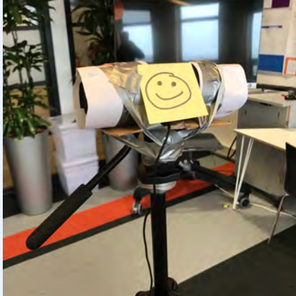
afb. 4 Rudimentair prototype van de Praatpaal: een speaker op een statief, aangesloten op een computer.
